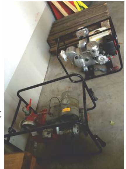
Bild: alte und neue Schmutzwasserpumpe im Vergleich.
