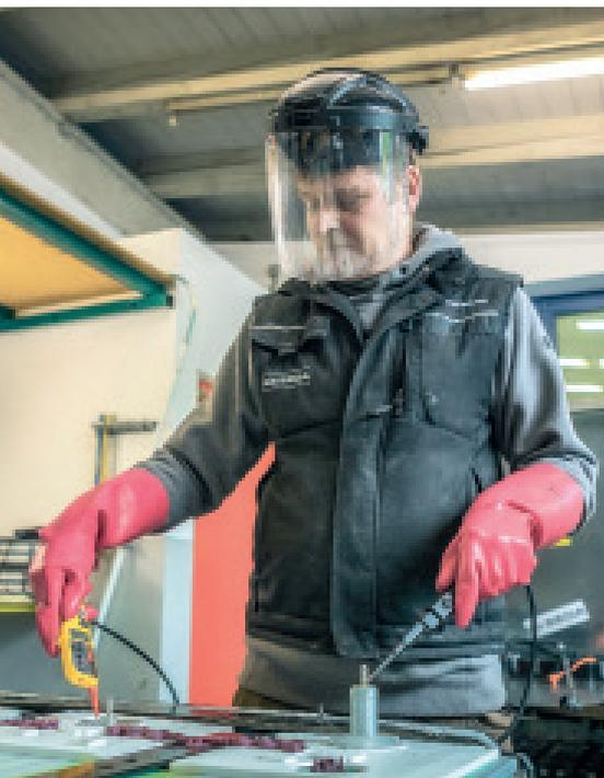
Profi-Umgang mit Unfall-Akkus: Schutzvisier, Handschuhe und isoliertes Werkzeug.
